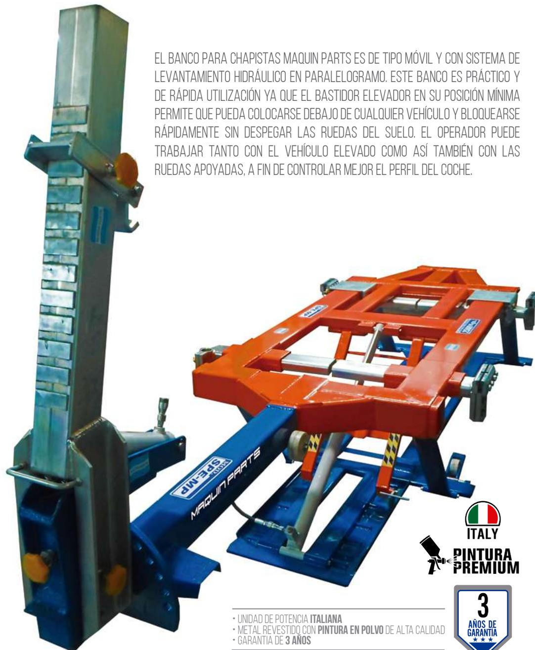
EL BANCO PARA CHAPISTAS MAQUIN PARTS ES DE TIPO MÓVIL Y CON SISTEMA DE LEVANTAMIENTO HIDRÁULICO EN PARALELOGRAMO. ESTE BANCO ES PRÁCTICO Y DE RÁPIDA UTILIZACIÓN YA QUE EL BASTIDOR ELEVADOR EN SU POSICIÓN MÍNIMA PERMITE QUE PUEDA COLOCARSE DEBAJO DE CUALQUIER VEHÍCULO Y BLOQUEARSE RÁPIDAMENTE SIN DESPEGAR LAS RUEDAS DEL SUELO. EL OPERADOR PUEDE TRABAJAR TANTO CON EL VEHÍCULO ELEVADO COMO ASÍ TAMBIÉN CON LAS RUEDAS APOYADAS, A FIN DE CONTROLAR MEJOR EL PERFIL DEL COCHE.
