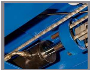
MONO CILINDRO HIDRÁULICO MONTADO DEBAJO DE LA PLATAFORMA.
