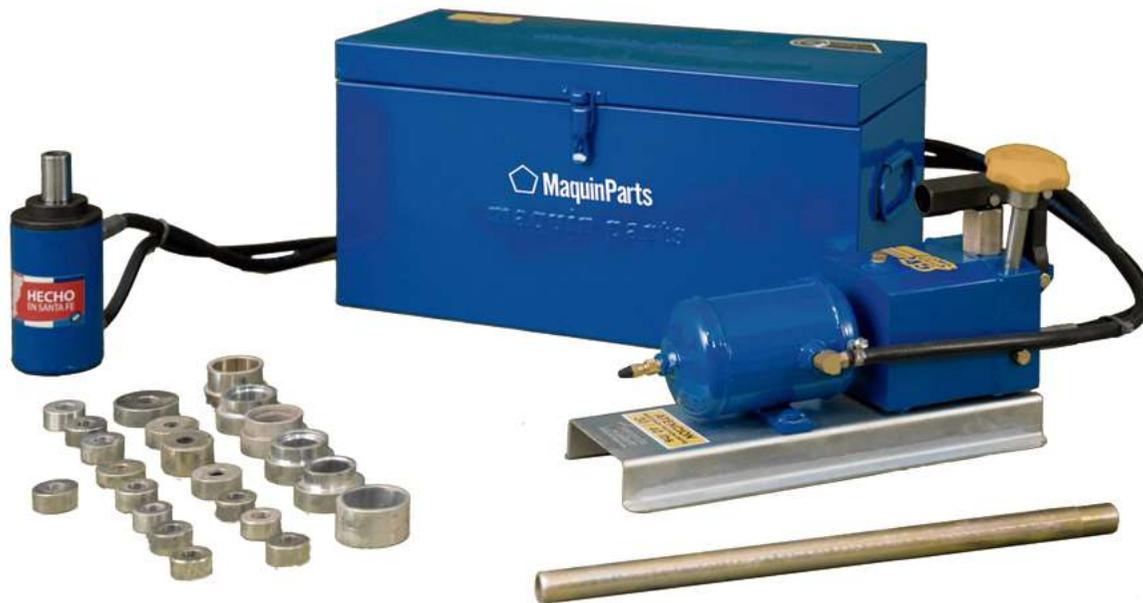
EL EXTRACTOR DE BUJES MAQUIN PARTS ES UN EQUIPO ÚNICO EN EL PAÍS, EL CUAL NO PUEDE FALTAR EN UN TALLER MECÁNICO ESPECIALIZADO EN TREN DELANTERO. ES UNA RÁPIDA Y EFICAZ HERRAMIENTA QUE PERMITE SACAR O COLOCAR BUJES DE PARRILLAS DE SUSPENSIÓN O TENSORES COLOCADOS EN EL VEHÍCULO O FUERA DEL MISMO.
