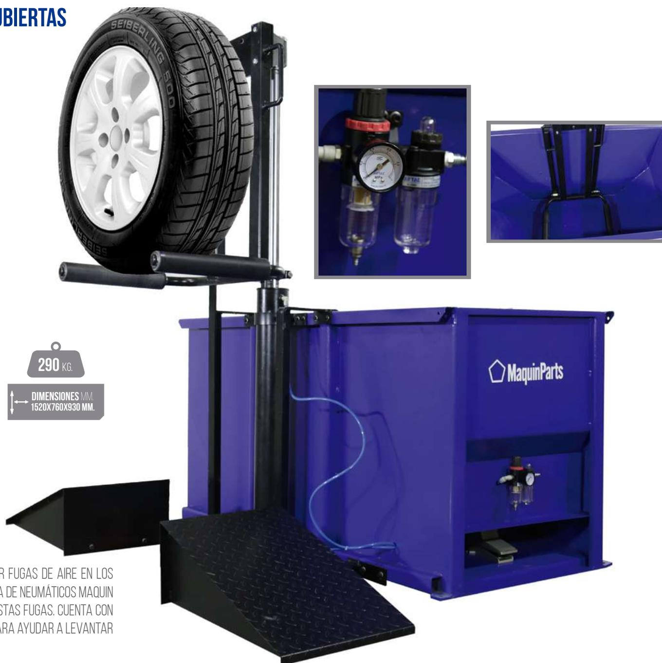
NO EXISTE UNA MANERA MÁS RÁPIDA O PRECISA DE ENCONTRAR FUGAS DE AIRE EN LOS NEUMÁTICOS DE AUTOMÓVILES O CAMIONES. EL TANQUE DE PRUEBA DE NEUMÁTICOS MAQUIN PARTS REDUCE EL ESFUERZO Y EL TIEMPO DE LOCALIZACIÓN DE ESTAS FUGAS. CUENTA CON UN ELEVADOR NEUMÁTICO DE RUEDAS QUE FUNCIONA CON EL PIE PARA AYUDAR A LEVANTAR NEUMÁTICOS PESADOS Y EVITAR LESIONES EN EL OPERARIO.
